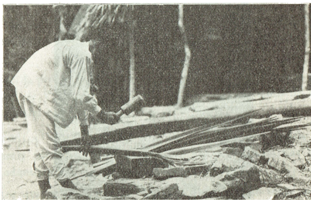
Machacado de una penca de lechuguilla. Operación previa a la extracción de la fibra.
